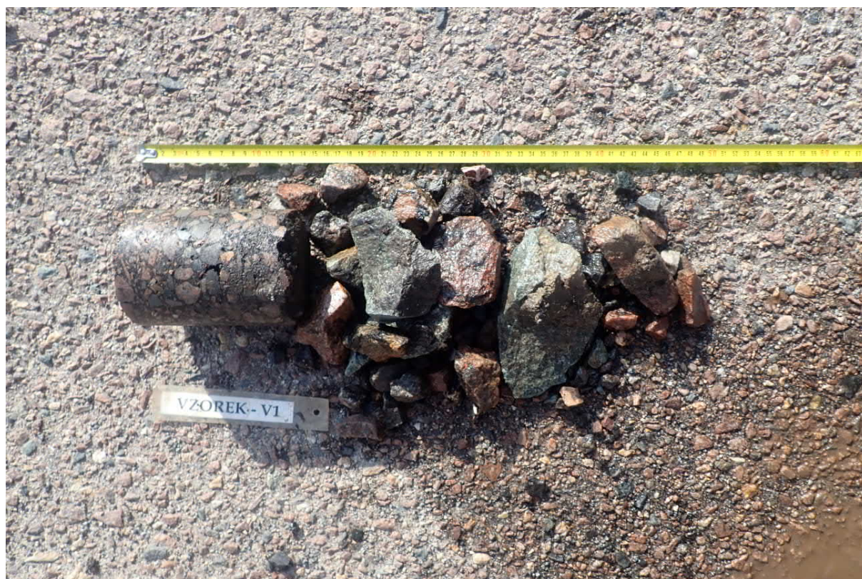
Obr. 1 - Jádro vývrtu Vzorek – V1 (in situ).
