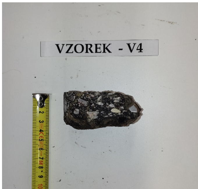
Obr. 8 - Jádru vývrtu Vzorek – V4 (laboratoř).
