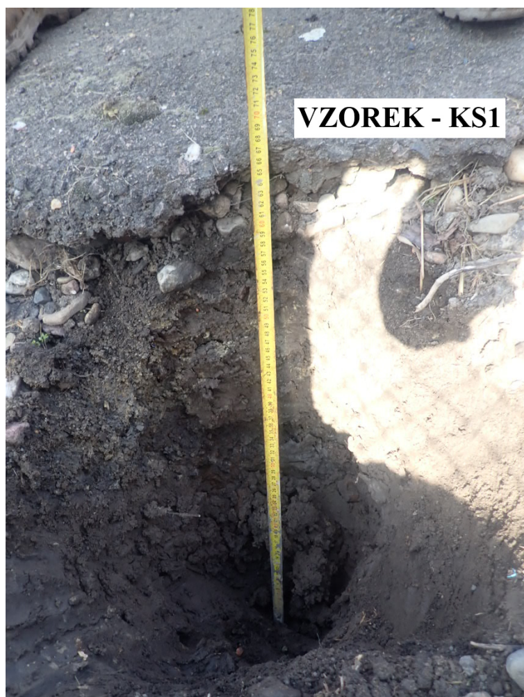
Obr. 9 – Kopaná sonda Vzorek – KS1 (in situ).
