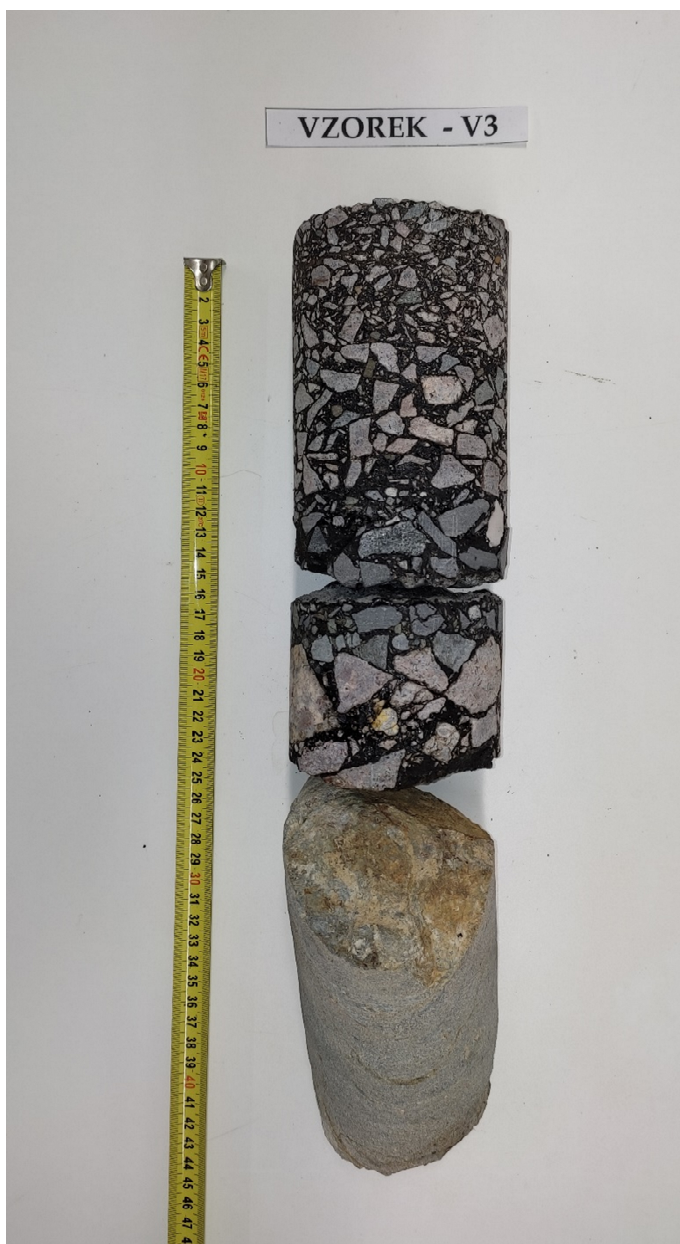
Obr. 6 - Jádru vývrtu Vzorek – V3 (laboratoř).
