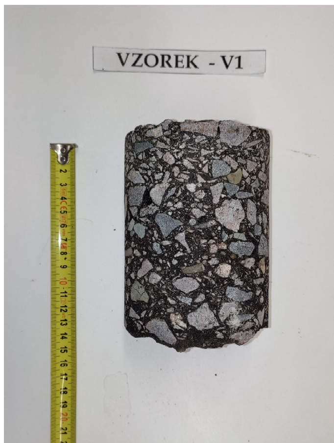
Obr. 2 - Jádru vývrtu Vzorek – V1 (laboratoř).
