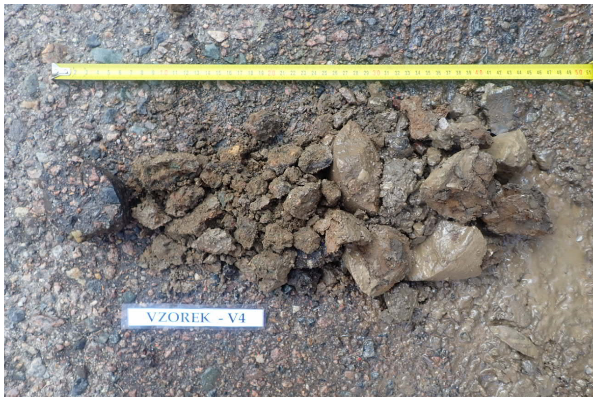
Obr. 7 - Jádro vývrtu Vzorek – V4 (in situ).
